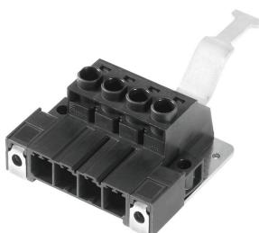
Conecotor macho de alto rendimiento con la reconocida conexión brida-tornillo de acero y totalmente exenta de mantenimiento de Weidmüller. Montaje en serie sin pérdida de polos o con sujeción multifunción patentada para un enclavamiento seguro, rápido y sin herramientas. La mejor fiabilidad de maniobra y funcionamiento gracias a una cara enchufable que impide errores de conexión, con diversidad de codificación única, protección contra cableado erróneo. Apto para señalización.
