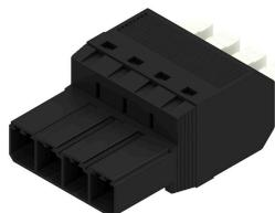
Conector macho invertido 180°, con conexión PUSH IN y actuador ajustable (pulsador), para conductores de 6 mm<sup>2</sup> en un paso de 7,62. También ideal como solución de protección frente al contacto con los dedos para tensiones inversas. Cumple los requerimientos de las normas UL 1059 600 V, clase C, e IEC 61800-5-1. Variantes: sin sujeción lateral, sujeción externa, sujeción intermedia enclavable y opcionalmente sujeción adicional por tornillo.
