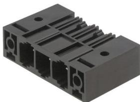
Conector macho de alto rendimiento, de una hilera, para montaje en serie sin pérdida de polos o con sujeción patentada para enclavamiento rápido sin herramientas. La mejor fiabilidad de maniobra y funcionamiento gracias a una cara enchufable que impide errores de conexión, con diversidad de codificación única y sujeción adicional. La longitud del pin de 3,5 mm está optimizada para soldadura por ola, con dirección de montaje de 270° a los pines de soldadura.
