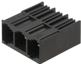
Conector macho para alta intensidad, de una hilera, para montaje en serie sin pérdida de polos o con sujeción patentada para enclavamiento rápido sin herramientas. La mejor fiabilidad de maniobra y funcionamiento gracias a una cara enchufable que impide errores de conexión, con diversidad de codificación única y sujeción adicional. La longitud del pin de 3,5 mm está optimizada para soldadura por ola, con dirección de montaje de 90° a los pines de soldadura.
