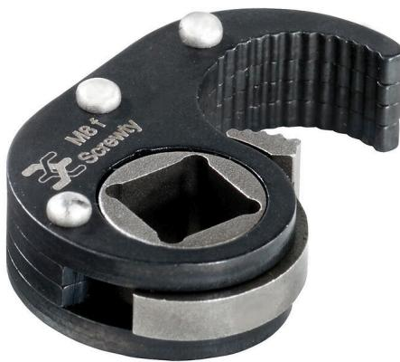
El accesorio Screwty® es compatible con los conectores redondos M8 personalizables, con una dimensión exterior de la tuerca estriada de  $11,9 \pm 0,3$  mm. El par de apriete es de 0,5-0,6 Nm.
