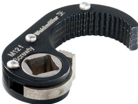
El accesorio Screwty® es compatible con los conectores M12 personalizables, con una dimensión exterior de la tuerca estriada de  $19,8 \pm 0,3$  mm. El par de apriete es de 0,8-1,2 Nm.
