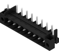
Conecotor macho abierto, recto y resistente a altas temperaturas. Embalaje en caja o cinta. En cinta, con pin de soldadura de 1,5 mm, optimizado para el montaje automático. Pin de soldadura de 3,2 mm, indicado para soldadura reflow y por ola. Los conectores macho disponen de espacio para señalización y se pueden codificar. HC = Alta intensidad
