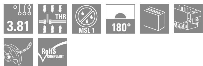
Conector macho resistente a altas temperaturas (SC-SMT 180LF) con paso de 3,81 mm (0,15 pulgadas)
