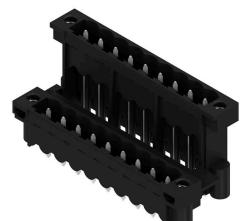
Conecotor macho resistente a altas temperaturas, de doble piso, desplazado lateralmente con brida o brida para soldadura. Terminal de soldadura de 1,5 mm idóneo para aplicaciones de soldadura reflow. Terminal de soldadura de 3,2 mm idóneo para soldadura Reflow y por ola. Los conectores macho ofrecen espacio para rotulación y se pueden codificar.
