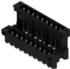
Conector macho resistente a altas temperaturas, de doble piso, desplazado lateralmente con brida o brida para soldadura. Terminal de soldadura de 1,5 mm idóneo para aplicaciones de soldadura reflow. Terminal de soldadura de 3,2 mm idóneo para soldadura Reflow y por ola. Los conectores macho ofrecen espacio para rotulación y se pueden codificar.
