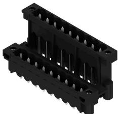
Conejero macho resistente a altas temperaturas, de doble piso, desplazado lateralmente con brida o brida para soldadura. Terminal de soldadura de 1,5 mm idóneo para aplicaciones de soldadura reflow. Terminal de soldadura de 3,2 mm idóneo para soldadura Reflow y por ola. Los conectores macho ofrecen espacio para rotulación y se pueden codificar.
