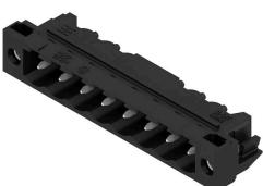
Conecotor macho resistente a altas temperaturas, embalado en caja o cinta. En cinta, con pin de soldadura de 1,5 mm, optimizado para el montaje automático. Pin de soldadura de 3,2 mm, indicado para soldadura reflow y por ola. Los conectores macho disponen de espacio para señalización y se pueden codificar. HC = Alta intensidad
