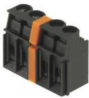
La tensión máxima depende de la distancia mínima. Las placas intermedias aumentan las distancias de línea de fuga y en el aire entre distintos potenciales y permiten tensiones nominales más altas o una separación clara, por ejemplo, entre red y baja tensión o entre diferentes zonas de protección.
