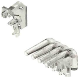
Eficaz: el enlace entre el LED y el panel frontal. Los indicadores tipo proyector permiten supervisar los estados de conmutación sin necesidad de un diseño especial: un plástico óptico dirige la luz de los LED estándar en ángulo hacia los conectores o a través de la placa frontal.
