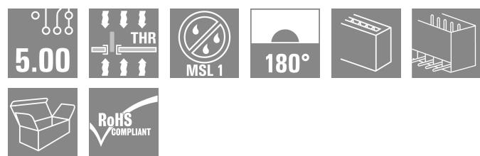
Conector macho resistente a altas temperaturas, embalado en caja o cinta. En cinta, con pin de soldadura de 1,5 mm, optimizado para el montaje automático. Pin de soldadura de 3,2 mm, indicado para soldadura reflow y por ola. Los conectores macho disponen de espacio para señalización y se pueden codificar. HC = Alta intensidad
