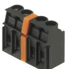
La tensión máxima depende de la distancia mínima. Las placas intermedias aumentan las distancias de línea de fuga y en el aire entre distintos potenciales y permiten tensiones nominales más altas o una separación clara, por ejemplo, entre red y baja tensión o entre diferentes zonas de protección.
