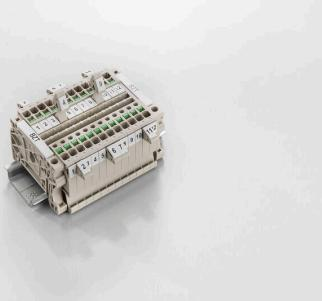
El soporte para señalizadores ofrece la posibilidad de montar adicionalmente señalizadores estándar con un paso de 5 ó 5,1 mm. Los soportes acodados se pueden encajar opcionalmente y se pueden montar en todos los canales de señalización estándar de los bornes modulares Klippon® Connect. Los tipos de señalizadores de ajuste se pueden encontrar en los respectivos accesorios del soporte de señalización.
