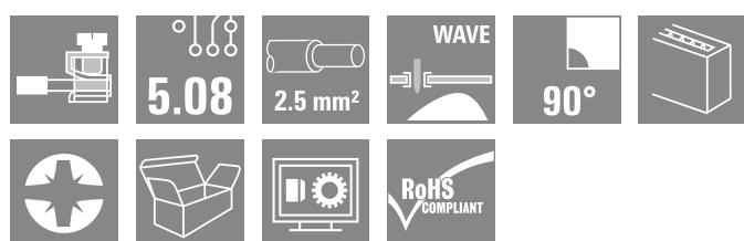
Borne para placas de circuitos impresos con conexión hembra por pisador con paso de 5,00 y 5,08 mm. Dirección de salida del conductor de 90°. Idóneo para secciones de conductor de hasta 2,5 mm<sup>2</sup>.
