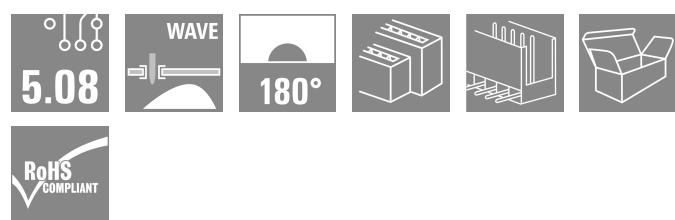
Conectores macho con longitud de pin de soldadura optimizada para la soldadura por ola. Los conectores macho ofrecen espacio para la señalización y se pueden codificar. HC = Alta intensidad
