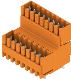
Conejero macho de doble nivel escalonado, para soldadura por ola, en paso de 3,50 mm. Disponible en versión cerrada y con sujeción lateral. Los conectores macho ofrecen espacio para la señalización y se pueden codificar.
