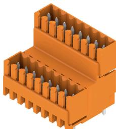
Conecotor macho de doble nivel escalonado, para soldadura por ola, en paso de 3,50 mm. Disponible en versión cerrada y con sujeción lateral. Los conectores macho ofrecen espacio para la señalización y se pueden codificar.
