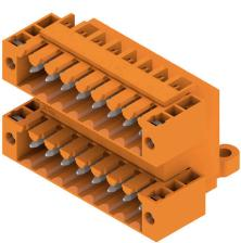
Conectores macho de doble piso para procedimiento de soldadura por ola, con paso de 3,50 mm. El conector está disponible en variante abierta, cerrada y con sujeción lateral. Los conectores macho ofrecen espacio para la señalización y se pueden codificar. Embalaje en caja de cartón.
