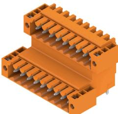
Conector macho de doble nivel escalonado, para soldadura por ola, en paso de 3,50 mm. Disponible en versión cerrada y con sujeción lateral. Los conectores macho ofrecen espacio para la señalización y se pueden codificar.
