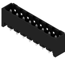
Conector macho resistente a altas temperaturas, embalado en caja o cinta. En cinta, con pin de soldadura de 1,5 mm, optimizado para el montaje automático. Pin de soldadura de 3,2 mm, indicado para soldadura reflow y por ola. Los conectores macho disponen de espacio para señalización y se pueden codificar. HC = Alta intensidad
