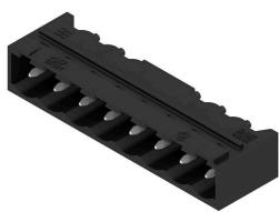
Conecotor macho resistente a altas temperaturas, embalado en caja o cinta. En cinta, con pin de soldadura de 1,5 mm, optimizado para el montaje automático. Pin de soldadura de 3,2 mm, indicado para soldadura reflow y por ola. Los conectores macho disponen de espacio para señalización y se pueden codificar. HC = Alta intensidad
