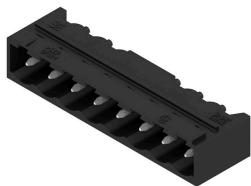
Conecotor macho resistente a altas temperaturas, embalado en caja o cinta. En cinta, con pin de soldadura de 1,5 mm, optimizado para el montaje automático. Pin de soldadura de 3,2 mm, indicado para soldadura reflow y por ola. Los conectores macho disponen de espacio para señalización y se pueden codificar. HC = Alta intensidad
