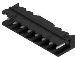
Conector macho resistente a altas temperaturas, acodado 90°, abierto. Embalaje en caja o cinta. En cinta, con pin de soldadura de 1,5 mm, optimizado para el montaje automático. Pin de soldadura de 3,2 mm, indicado para soldadura reflow y por ola. Los conectores macho disponen de espacio para señalización y se pueden codificar. HC = Alta intensidad
