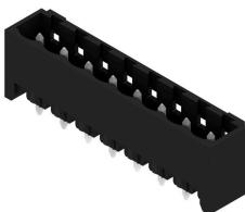
Conecotor macho resistente a altas temperaturas, embalado en caja o cinta. En cinta, con pin de soldadura de 1,5 mm, optimizado para el montaje automático. Pin de soldadura de 3,2 mm, indicado para soldadura reflow y por ola. Los conectores macho disponen de espacio para señalización y se pueden codificar. HC = Alta intensidad
