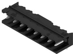
Conecotor macho resistente a altas temperaturas, acodado 90°, abierto. Embalaje en caja o cinta. En cinta, con pin de soldadura de 1,5 mm, optimizado para el montaje automático. Pin de soldadura de 3,2 mm, indicado para soldadura reflow y por ola. Los conectores macho disponen de espacio para señalización y se pueden codificar. HC = Alta intensidad
