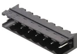
Conecotor macho abierto, recto y resistente a altas temperaturas. Embalaje en caja o cinta. En cinta, con pin de soldadura de 1,5 mm, optimizado para el montaje automático. Pin de soldadura de 3,2 mm, indicado para soldadura reflow y por ola. Los conectores macho disponen de espacio para señalización y se pueden codificar. HC = Alta intensidad
