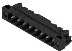
Conejero macho resistente a altas temperaturas, embalado en caja o cinta. En cinta, con pin de soldadura de 1,5 mm, optimizado para el montaje automático. Pin de soldadura de 3,2 mm, indicado para soldadura reflow y por ola. Los conectores macho disponen de espacio para señalización y se pueden codificar. HC = Alta intensidad
