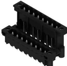
Conecotor macho resistente a altas temperaturas, de doble piso, desplazado lateralmente con brida o brida para soldadura. Terminal de soldadura de 1,5 mm idóneo para aplicaciones de soldadura reflow. Terminal de soldadura de 3,2 mm idóneo para soldadura Reflow y por ola. Los conectores macho ofrecen espacio para rotulación y se pueden codificar.
