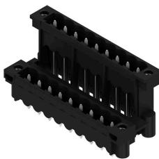
Conejero macho resistente a altas temperaturas, de doble piso, desplazado lateralmente con brida o brida para soldadura. Terminal de soldadura de 1,5 mm idóneo para aplicaciones de soldadura reflow. Terminal de soldadura de 3,2 mm idóneo para soldadura Reflow y por ola. Los conectores macho ofrecen espacio para rotulación y se pueden codificar.
