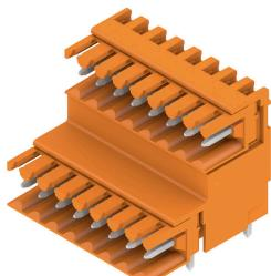
Conector macho de doble nivel escalonado, para soldadura por ola, en paso de 3,50 mm. Disponible en versión cerrada y con sujeción lateral. Los conectores macho ofrecen espacio para la señalización y se pueden codificar.
