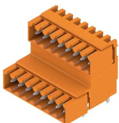
Conecotor macho de doble nivel escalonado, para soldadura por ola, en paso de 3,50 mm. Disponible en versión cerrada y con sujeción lateral. Los conectores macho ofrecen espacio para la señalización y se pueden codificar.
