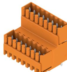
Conector macho de doble nivel escalonado, para soldadura por ola, en paso de 3,50 mm. Disponible en versión cerrada y con sujeción lateral. Los conectores macho ofrecen espacio para la señalización y se pueden codificar.
