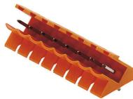
Conectores macho con dirección de salida 135°. La longitud del terminal de soldadura está optimizada para la utilización de soldadura por ola. Los conectores macho ofrecen espacio para rotulación y se pueden codificar.
