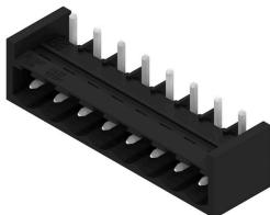
Conecotor macho abierto, recto y resistente a altas temperaturas. Embalaje en caja o cinta. En cinta, con pin de soldadura de 1,5 mm, optimizado para el montaje automático. Pin de soldadura de 3,2 mm, indicado para soldadura reflow y por ola. Los conectores macho disponen de espacio para señalización y se pueden codificar. HC = Alta intensidad
