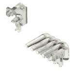
Eficaz: el enlace entre el LED y el panel frontal. Los indicadores tipo proyector permiten supervisar los estados de conmutación sin necesidad de un diseño especial: un plástico óptico dirige la luz de los LED estándar en ángulo hacia los conectores o a través de la placa frontal.
