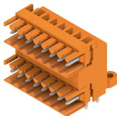
Conecotores macho de doble piso para procedimiento de soldadura por ola, con paso de 3,50 mm. El conector está disponible en variante abierta, cerrada y con sujeción lateral. Los coneccotores macho ofrecen espacio para la señalización y se pueden codificar. Embalaje en caja de cartón.
