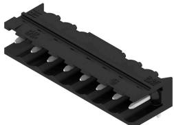
Conector macho resistente a altas temperaturas, acodado 90°, abierto. Embalaje en caja o cinta. En cinta, con pin de soldadura de 1,5 mm, optimizado para el montaje automático. Pin de soldadura de 3,2 mm, indicado para soldadura reflow y por ola. Los conectores macho disponen de espacio para señalización y se pueden codificar. HC = Alta intensidad
