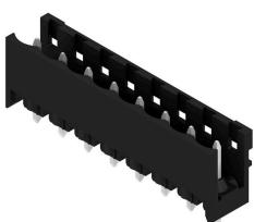
Conector macho abierto, recto y resistente a altas temperaturas. Embalaje en caja o cinta. En cinta, con pin de soldadura de 1,5 mm, optimizado para el montaje automático. Pin de soldadura de 3,2 mm, indicado para soldadura reflow y por ola. Los conectores macho disponen de espacio para señalización y se pueden codificar. HC = Alta intensidad
