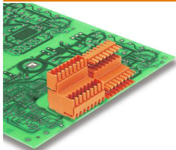
Conector macho de doble nivel escalonado, para soldadura por ola, en paso de 3,50 mm. Disponible en versión cerrada y con sujeción lateral. Los conectores macho ofrecen espacio para la señalización y se pueden codificar.
