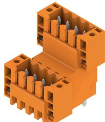
Conector macho de doble nivel escalonado, para soldadura por ola, en paso de 3,50 mm. Disponible en versión cerrada y con sujeción lateral. Los conectores macho ofrecen espacio para la señalización y se pueden codificar.
