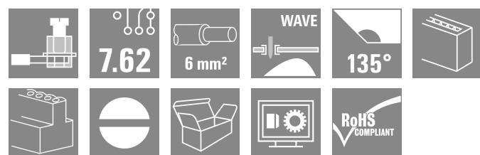
Este borne para placas de circuitos impresos ofrece conexión para conductores con sección de 6 mm<sup>2</sup>, 1000 V, 32 A, toma de prueba, conexión por brida-tornillo probada con paso de 7,50 mm y 7,62 mm y dirección de salida del conductor de 135°.
