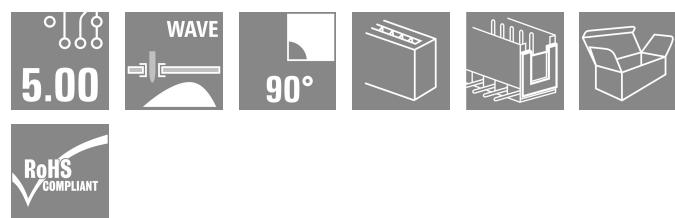
Conectores macho con dirección de salida 90°. La longitud del terminal de soldadura está optimizada para la utilización de soldadura por ola. Los conectores macho ofrecen espacio para rotulación y se pueden codificar.
