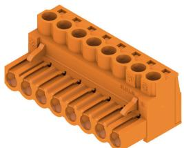
Conector hembra con conexión brida-tornillo para conexión de conductores con dirección de salida recta (180°). Los conectores hembra ofrecen espacio para la señalización y se pueden codificar. Sujetado mediante sujeción lateral o pasador de desbloqueo. Disponen también de un tornillo +/- integrado, protección contra inserción incorrecta del cable y se suministran con las bridas de embornado abiertas. HC = Alta intensidad
