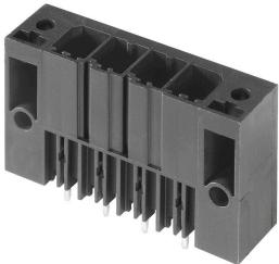
Conecotor macho de alto rendimiento, de una hilera, para montaje en serie sin pérdida de polos o con sujeción patentada para enclavamiento rápido sin herramientas. La mejor fiabilidad de maniobra y funcionamiento gracias a una cara enchufable que impide errores de conexión, con diversidad de codificación única y sujeción adicional. La longitud del pin de 3,5 mm está optimizada para soldadura por ola sin plomo.
