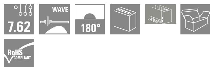
Conector macho de 180° con sujeción intermedia de 7,62 de paso. Cumple los requerimientos de IEC 61800-5-1 y admite homologación UL conforme a UL840 600 V.
