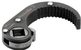
El accesorio Screwty® es compatible con los conectores redondos M23 personalizables y con los conectores redondos M23 sobremoldeados, con una dimensión exterior de la tuerca estriada de  $26,2 \pm 0,3$  mm. El par de apriete es de 2-2,5 Nm.
