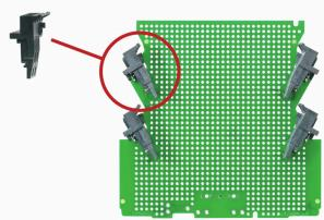
Conecador macho abierto, recto y resistente a altas temperaturas. Embalaje en caja o cinta. En cinta, con pin de soldadura de 1,5 mm, optimizado para el montaje automático. Pin de soldadura de 3,2 mm, indicado para soldadura reflow y por ola. Los conectores macho disponen de espacio para señalización y se pueden codificar. HC = Alta intensidad
