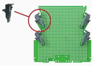
Conejor macho abierto, recto y resistente a altas temperaturas. Embalaje en caja o cinta. En cinta, con pin de soldadura de 1,5 mm, optimizado para el montaje automático. Pin de soldadura de 3,2 mm, indicado para soldadura reflow y por ola. Los conectores macho disponen de espacio para señalización y se pueden codificar. HC = Alta intensidad
