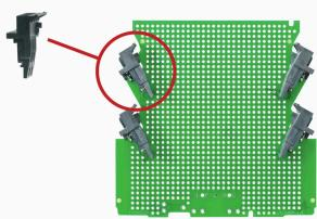
Conector macho abierto, recto y resistente a altas temperaturas. Embalaje en caja o cinta. En cinta, con pin de soldadura de 1,5 mm, optimizado para el montaje automático. Pin de soldadura de 3,2 mm, indicado para soldadura reflow y por ola. Los conectores macho disponen de espacio para señalización y se pueden codificar. HC = Alta intensidad
